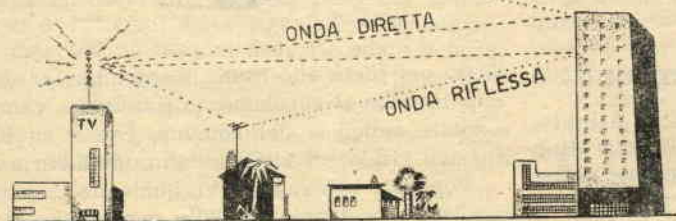
Fig. 4. — L'onda riflessa compie sempre un tragitto maggiore rispetto a quella diretta, perciò giunge sempre sullo schermo del televisore con un leggero ritardo, provocando lo sdoppiamento dell'immagine.
